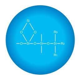
図のR1、R2、R3が、アルキル変性シリコンとシリカ変性アクリルレジンの構成と天然無機高分子とのハイブリッドを示しています。組成が均一になるように工夫をこらしてあり、塗装後の塗膜も成分が均一になるので疎水性にムラが起こりません。このように塗膜全体が完全な疎水性を持っており、一般塗料に撥水材を塗布したものとは異なるので、その疎水効果は長期に渡り持続します。
